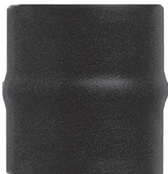
Tubo pellet vetro porcellanato nero. Classe di resistenza alla corrosione V2. Monoparete in acciaio al carbonio nello spessore di 0,8 mm con guarnizione siliconica HT inserita.
