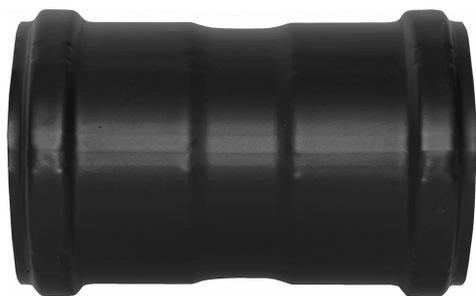
Tubo pellet vetro porcellanato nero. Classe di resistenza alla corrosione V2. Monoparete in acciaio al carbonio nello spessore di 0,8 mm con guarnizione siliconica HT inserita.
