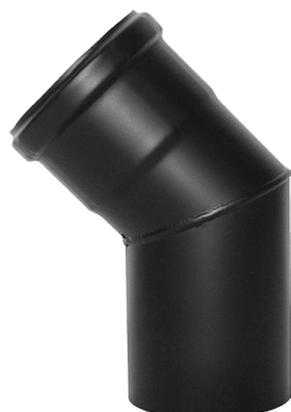
Tubo pellet vetro porcellanato nero. Classe di resistenza alla corrosione V2. Monoparete in acciaio al carbonio nello spessore di 0,8 mm con guarnizione siliconica HT inserita.
